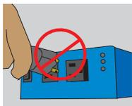
No conectar ningún generador eléctrico a la salida del inversor.
